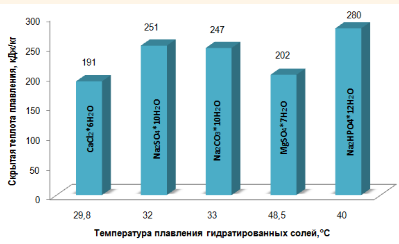
Рисунок 2. Зависимость скрытой теплоты плавления от температуры плавления гидратированных солей как ВФП
