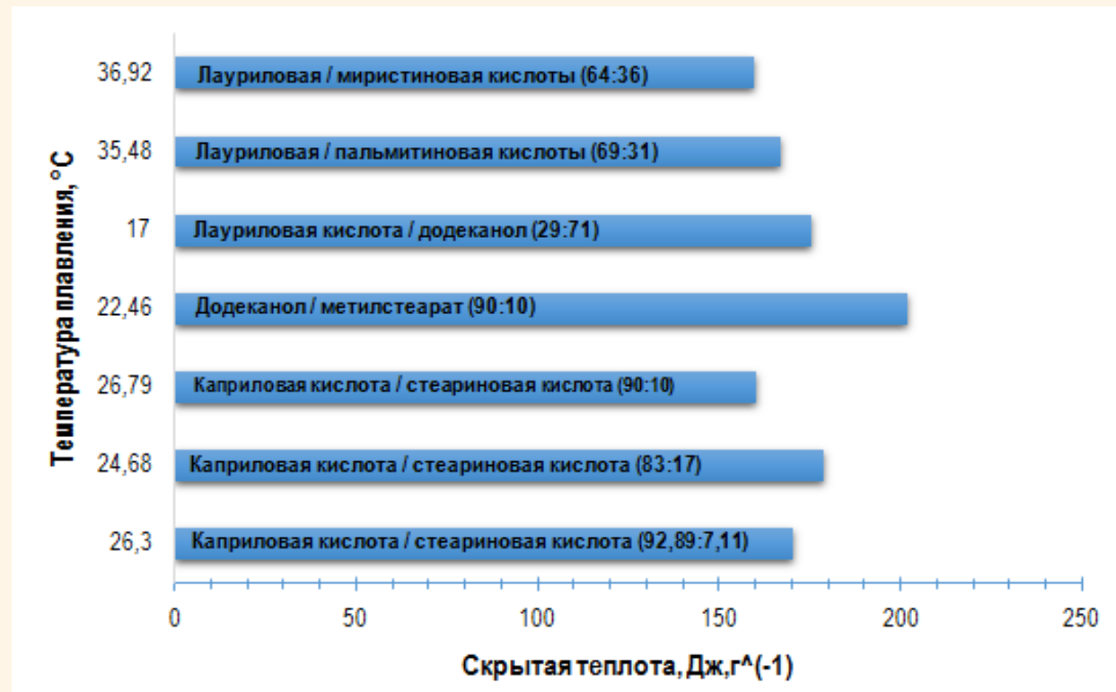
Рисунок 4. Сравнительная характеристика термофизических свойств эвтектических смесей органических ВФП
